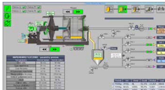
Fot. 4. Innowacyjny algorytm dozowania wody ekstrakcyjnej. W korelacji z ilością pobranego produktu ustandaryzowanie parametrów tłoczonego soku pod kątem ilości cukrów i zmniejszenia ilości zużywanej wody
