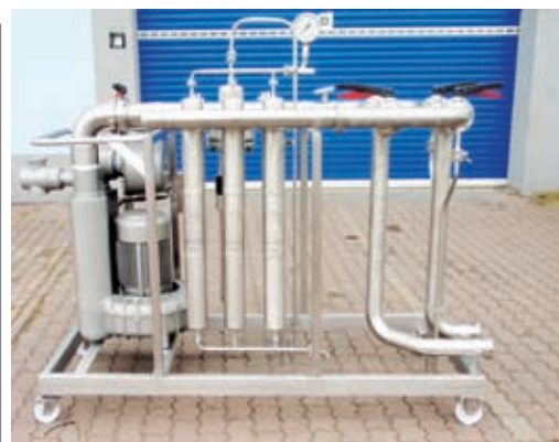
Fot. 2. Stacja napowietrzania zbiorników o dużej wydajności; widoczne od lewej: dmuchawa oraz trzy równoległe mikrobiologiczne filtry powietrza
